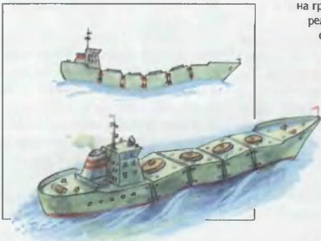
повторять профиль волн, нагрузки на корпус станут минимальными, а значит, и вероятность разлома судна значительно меньше. Секции же можно связать между собой системой тросов и шарниров.
